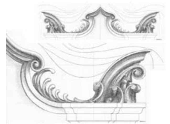
Obr. 13: Mikulov, synagoga, Výrobní dokumentace – Ing. arch. Matěj Barla a kol., kresby MgA. Jiří Kobr – detail římsy 3 – volutový tympanon, 2013
