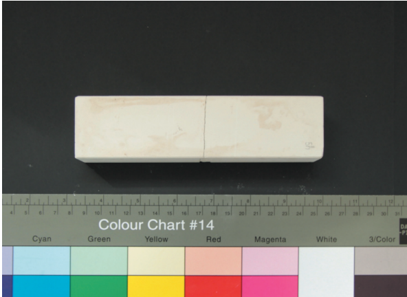
Obr. 5 Vzorky sádrových hranolů pro zkoušky pevnosti lepeného spoje. Foto: Aneta Kokstejnová.
